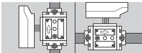
La valvola modulante lineare LFC e il servomotore IC sono forniti separatamente:
