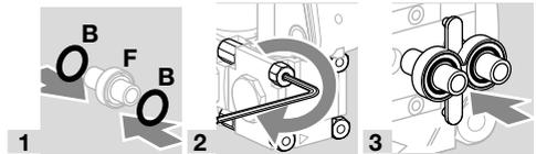
4 Bypass ventilinin montaj tarafında tapaları çıkarın.
