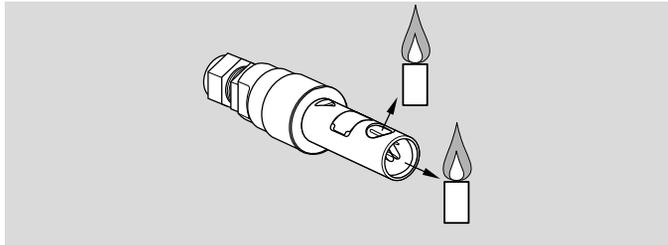
Über die Sichtöffnungen im Sondenkopf kann die UV-Röhre seitlich oder frontal auf die Flamme ausgerichtet werden.
