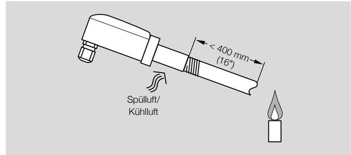
Die Montage erfolgt über den (mitgelieferten) Adapter mit integriertem Wärmeschutz aus Quarzglas an ein  $\frac{1}{2}$ " Sichtrohr. Das Sichtrohr sollte auf das erste Flammendrittel ausgerichtet sein, da hier im Allgemeinen die stärkste UV-Strahlung vorliegt. Das Sichtrohr sollte innen blank sein.
