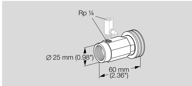
Mit Wärmeschutz aus Quarzglas und Anschluss Rp 1/4 für Düse.
