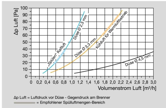
Für Kromschöder-Brenner (BIO, BIO, ZIO, ZIC) ist bei kalter Verbrennungsluft keine Spülluftdüse erforderlich.
