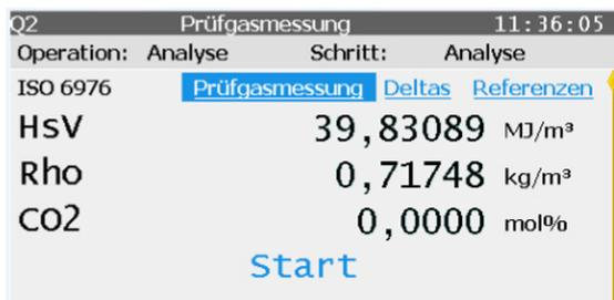
Abb. 7-37: Anzeige Q2 Steuerung mit Unteranzeigen
