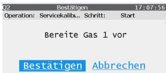
Die Prozedur startet automatisch. Zuerst wird mit Kalibriergasgemisch gespült. Dieses wird, wie auch die Dauer des Vorgangs angezeigt. Danach wird das Gas gemessen. Die Dauer dieses Vorgangs wird ebenfalls angezeigt.
