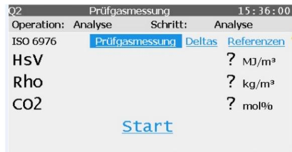
04 Die Analyse (laufende Messung) wird nicht mehr aktualisiert bzw. gestoppt. Das Gerät wartet auf eine Bestätigungseingabe.
