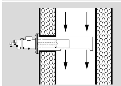
→ Le tube de protection de flamme FPT est utilisé pour des vitesses d'écoulement supérieures à 15 m/s afin de protéger la flamme contre le refroidissement.
