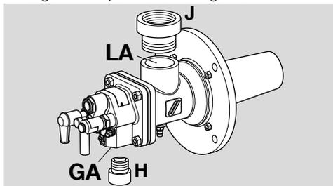
→ **BIO 125, BIO 140, BIOW** : pour le raccord d'air LA, souder la bride K au tube d'air P, et utiliser l'adaptateur taraudage NPT H pour le raccord gaz GA.
