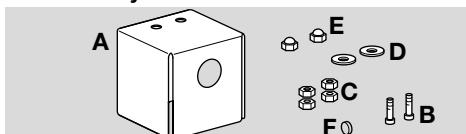
Ved utendørs montering er værbeskyttelseshetten en permanent beskyttelse for å unngå at det danner seg kondensvann og at husdelene forvitres.
