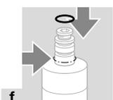
→ Quando o aparelho existente possui um anel O-ring em este ponto (seta), trocar o acionamento como descrito aqui: VAN 1: utilizar todas as vedações contidas no kit adaptador de acionamento. VAN 2: utilizar a vedação pequena e somente uma vedação grande do kit adaptador de acionamento.
