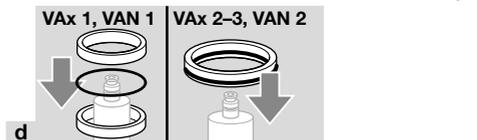
d Deslizar la junta bajo la segunda ranura.
