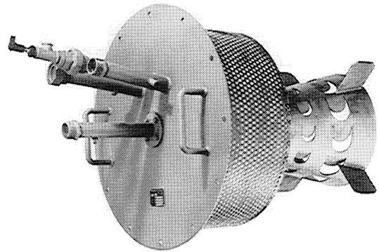
Eclipse Incinicone Brenner sind für den Einsatz in Nachverbrennungsanlagen von Abgasen (Prozeßluft) aus Trocknern, Öfen und ähnlichen Anlagen. Incinicone Brenner werden im Abgaskanal montiert, wo der Sauerstoffgehalt der Prozeßluft die komplette Verbrennung gewährleistet.
