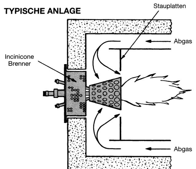
Stauplatzen werden für 5 mbar  $\Delta P$  der heißen Abgase über dem Brenner ausgelegt.
