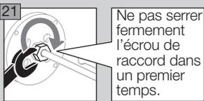
Ne pas serrer fermement l'écrou de raccord dans un premier temps.
