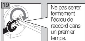
Ne pas serrer fermement l'écrou de raccord dans un premier temps.
