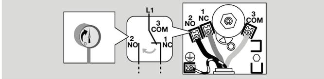
Druckwächter, die bei steigendem Druck schalten:
