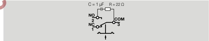
Bei hoher Luftfeuchtigkeit oder aggressiven Gasbestandteilen ( $H_2S$ ) empfehlen wir einen Druckwächter mit Goldkontakt aufgrund der höheren Korrosionsbeständigkeit. Eine Ruhestromüberwachung ist unter schwierigen Einsatzbedingungen empfehlenswert.
