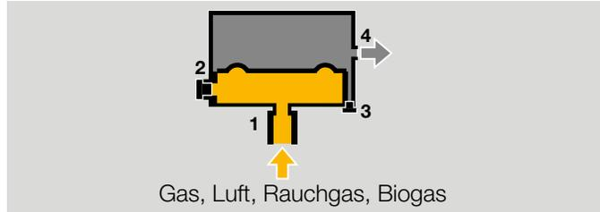
Der Überdruck wird über den Membranunterraum, Anschluss **1** (oder **2**), gemessen. Der Membranoberraum wird über den Anschluss **4** (oder **3**) belüftet.
