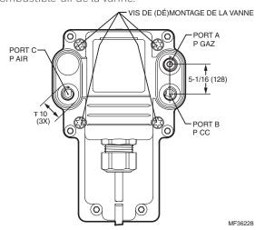
Fig. 3. Connexions des lignes d'impulsion du module de régulation du rapport combustible-air.
