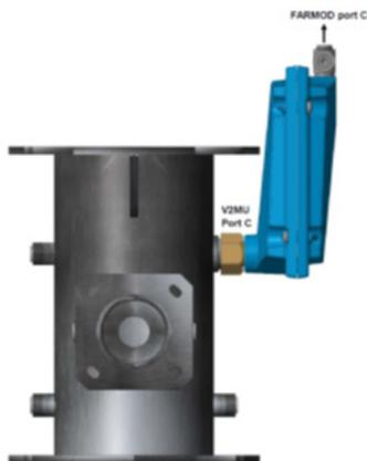
**Fig. 4. Exemple de montage de l'échangeur de chaleur, l'unité de mélange étant orientée verticalement (illustré avec l'unité de mélange 300kW).**
