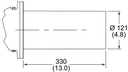
Hochgeschwindigkeits-Verbrennungsrohr und Verbrennungsrohr für mittlere Geschwindigkeit aus SiC
