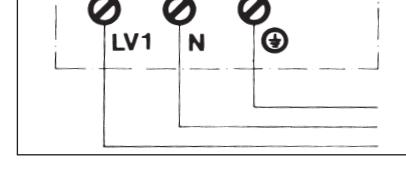
● En cas de manque de courant, l'arrêt de sécurité de la vanne doit être garanti: intercaler un dispositif d'isolation bipolaire (!) – interrupteur principal, sécurités ou autres – avec une ouverture de contact minimale de 3 mm.
