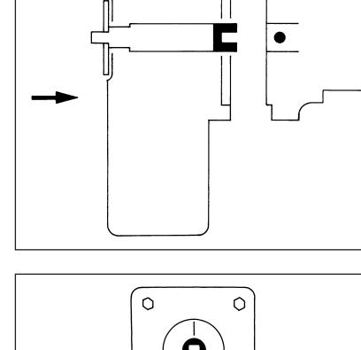
**Montage de la vanne de réglage dans la tuyauterie**
