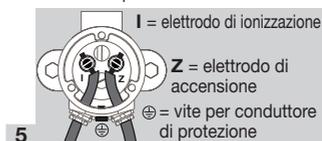
6 Tendere il conduttore di ionizzazione e di accensione a 5 Nm (vite con testa a intaglio), fissando l'elettrodo all'esagono per evitarne la torsione.
