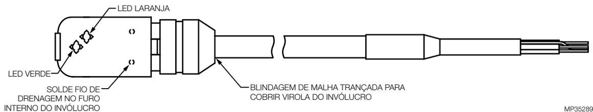
**Fig. 6. Local do fio de drenagem soldado.**
