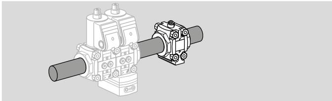
El diafragma de medición VMO sirve para estrangular el caudal del gas o del aire y se monta aguas abajo del dispositivo valVario. El diafragma de medición está disponible con rosca interior Rp (rosca interior NPT) o con brida según ISO 7005.
