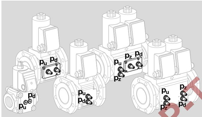
La presión de entrada  $p_u$ , la presión del espacio intermedio  $p_z$  así como la presión de salida  $p_d$  se pueden medir en ambos lados mediante tomas de presión.
