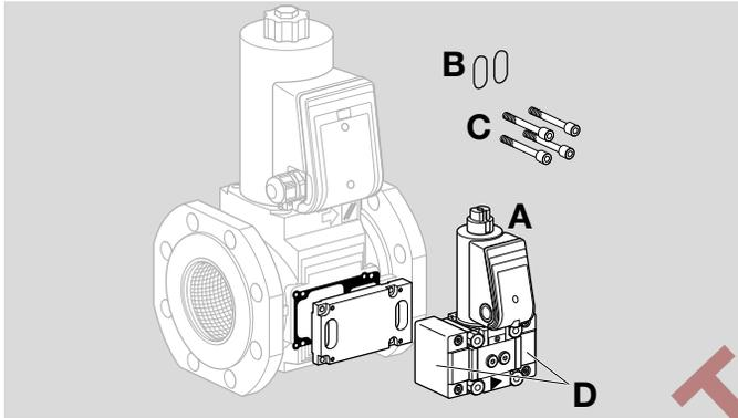
**A** 1 válvula de bypass o de gas de encendido VAS 1,
