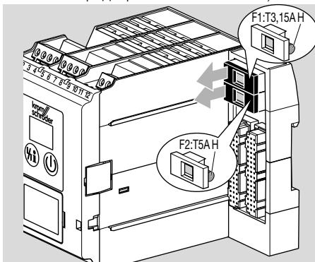
5 Проверьте работоспособность слаботочного предохранителя F1 или F2.
