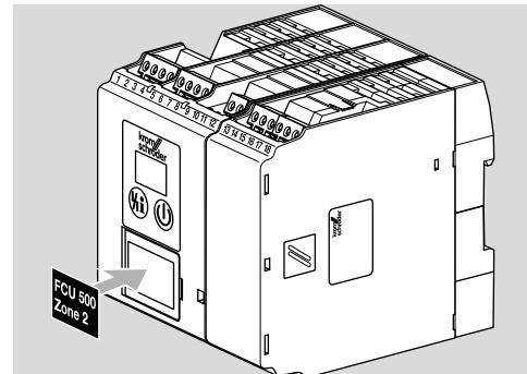
Печать на лазерном принтере, плоттере или гравировальном станке, 27 × 18 мм или 28 × 17,5 мм. Цвет: серебристый.
