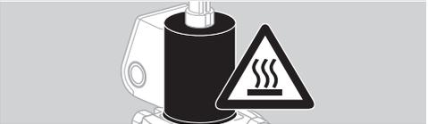
→ Utilizzare un cavo termoresistente (> 90 °C).
