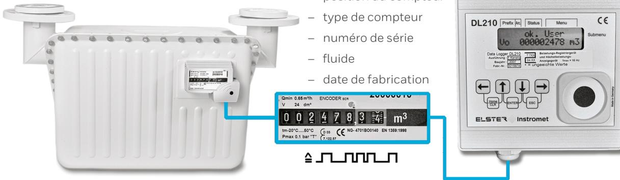
Représentation schématique de la transmission de la position originale du compteur au Data Logger DL 210 par l'intermédiaire de l'interface SCR. Le totalisateur à ENCODEUR absolu est disponible avec les versions d'interfaces M-BUS ou SCR.
