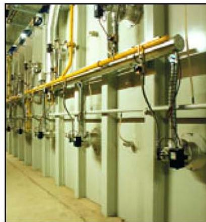
Figure 4 - Système de chauffage d'un four tunnel pour pavés de clinker
