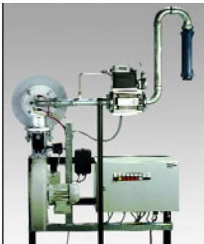
Figure 3 - Brûleur ZIO 165 avec arrivée d'air étagée pour le séchage
