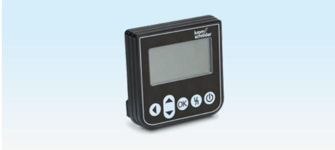
L'OCU est une unité de commande externe pouvant être raccordée à un appareil de commande de la série FCU 500 / BCU 500. L'unité de commande externe OCU peut être montée par ex. dans la porte d'une armoire électrique. L'armoire électrique ne doit donc pas être ouverte pour lire les valeurs process, les statistiques, l'intensité du signal de flamme ou les valeurs de paramètres, pour modifier les paramètres de l'OCU ou pour commander et ajuster les vannes papillon raccordées en mode manuel.
