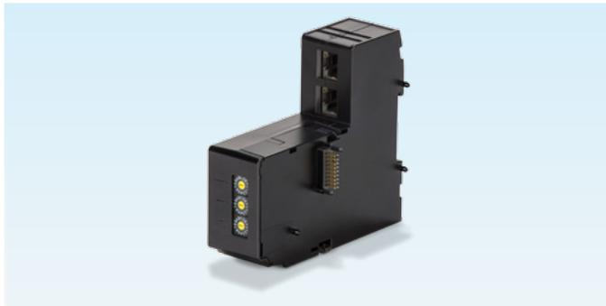
Le module bus BCM 500 sert d'interface de communication pour les appareils de la famille de produits BCU/FCU 500 dans le cadre d'une intégration à un réseau Profinet. L'interconnexion via Profinet permet de commander et de contrôler le FCU ou le BCU depuis un système d'automatisation (par ex. API).
