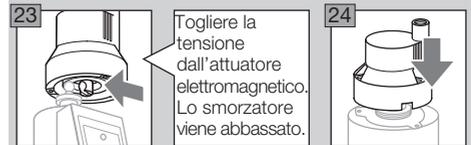
Togliere la tensione dall'attuatore elettromagnetico. Lo smorzatore viene abbassato.
