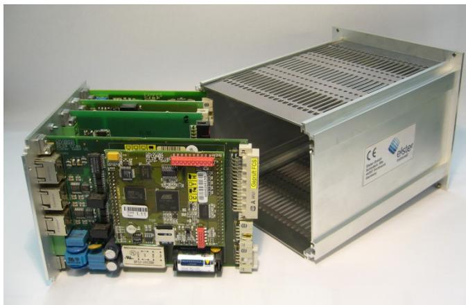
插图 5-4: 拆下的卡框
