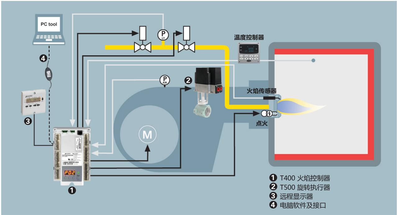
T400 火焰控制器应用于典型燃气调节燃烧器控制系统
