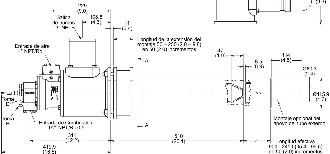
Los tubos exteriores de la versión 5 tienen un diámetro de brida más largo que versiones anteriores. Tubos de versiones anteriores no pueden utilizarse en la versión 5. Pónganse en contacto con el fabricante para actualizar el diseño del quemador para utilizar tubos de versiones anteriores.
