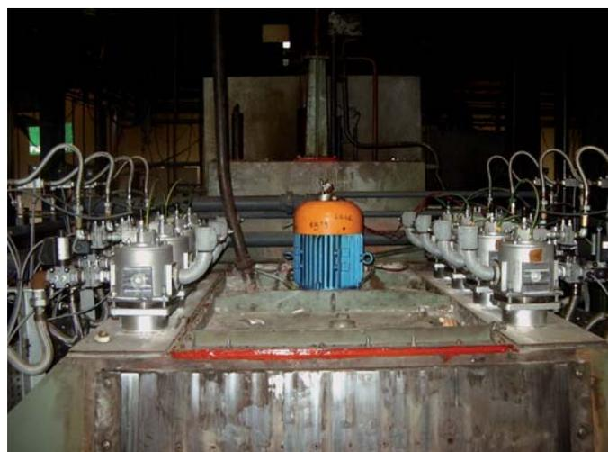
**Bild 5a/b:** Ansicht der Ofendecke des Härteofens vor (links) und nach (rechts) der Modernisierung mit ECOMAX® Rekupe-ratorbrennern
