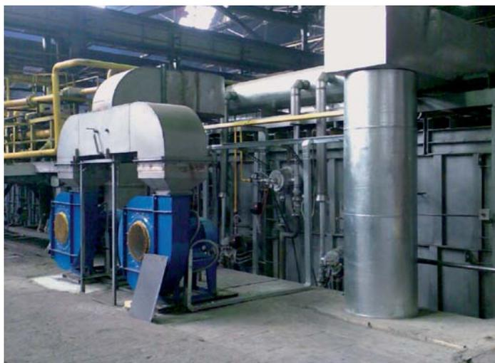
**Bild 4:** Ansicht des Stoßofens nach der Umrüstung auf ECOMAX® Rekupe-ratorbrenner
