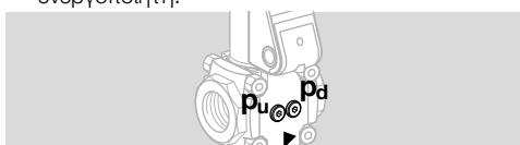
→ Η πίεση εισόδου  $p_u$  και η πίεση εξόδου  $p_d$  μπορούν να μετρηθούν και στις δύο πλευρές των στομίων μέτρησης, βλέπε εξαρτήματα.
