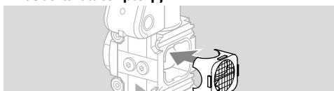
→ Όταν ο ρυθμιστής πίεσης VAD/VAG/VAV 1 ενσωματωθεί μεταγενέστερα πριν από την ηλεκτρομαγνητική βαλβίδα αερίου VAS 1, πρέπει στην έξοδο του ρυθμιστή πίεσης να είναι τοποθετημένο ένθετο ανταπόκρισης DN 25 με με το άνοιγμα εξόδου  $d = 30$  mm (1,18"). Σε ρυθμιστή πίεσης VAX 115 ή VAX 120 πρέπει να παραγγείλετε μεμονωμένα το ένθετο ανταπόκρισης DN 25 και να εξοπλιστεί εκ νέου, κωδ. παραγγελίας 74922240.
