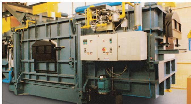
*Régulateur de proportion sur four de fusion assurant une combustion stoechiométrique sur toute la plage de puissance*
