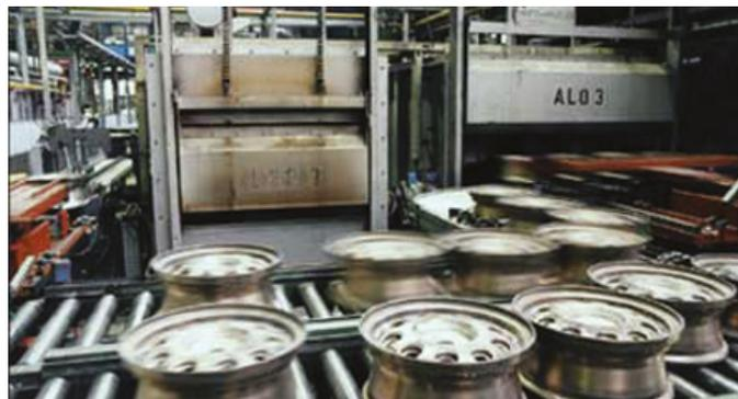
*Four de durcissement pour l'aluminium avec régulateurs de proportion servant de coupe-air*
