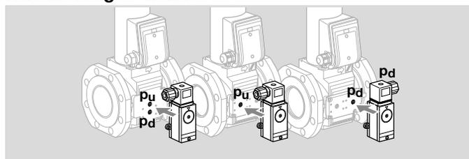
Contrôle de la pression amont  $p_u$  : le pressostat gaz est monté du côté amont.
