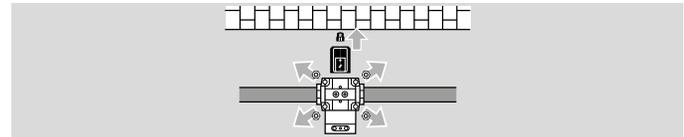
Veiller à un espace libre suffisant pour le montage, le réglage et la maintenance. Écart minimal de 25 cm (9,8 pouce) au-dessus de la commande magnétique noire.
