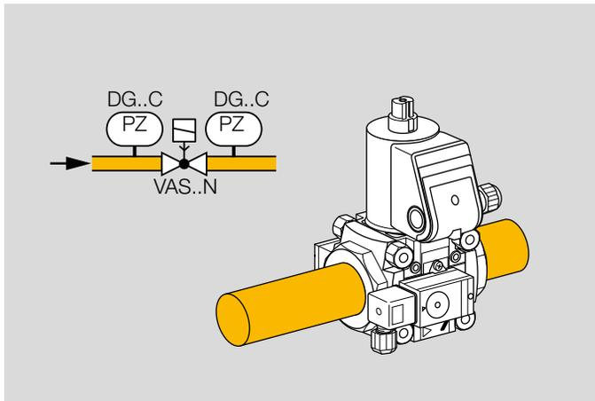
VAS..N à ouverture rapide, pressostat DG..C pour pression amont  $p_U$  et pression aval  $p_D$
