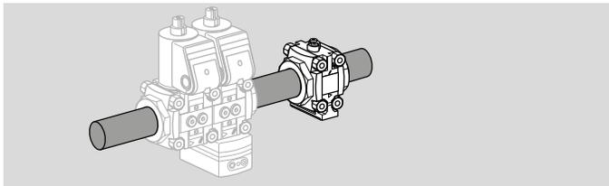
Les débits de gaz et d'air sont réduits par le diaphragme de mesure VMO qui est installé en aval de la vanne valVario. Le diaphragme de mesure peut être livré avec taraudage Rp (taraudage NPT) ou bride selon ISO 7005.
