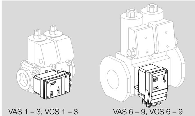
Le contrôleur d'étanchéité TC 1V et la vanne de by-pass/pilote ne peuvent pas être montés d'un seul côté du bloc vannes à deux vannes.
