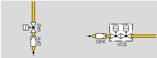
Position de montage : commande magnétique noire placée à la verticale ou couchée à l'horizontale, pas à l'envers.
