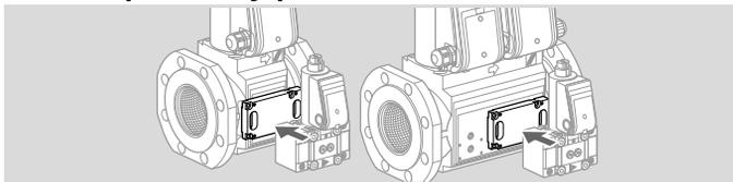
Pour le raccordement de la vanne de by-pass/pilote VAS 1. n° réf. 74923023.
