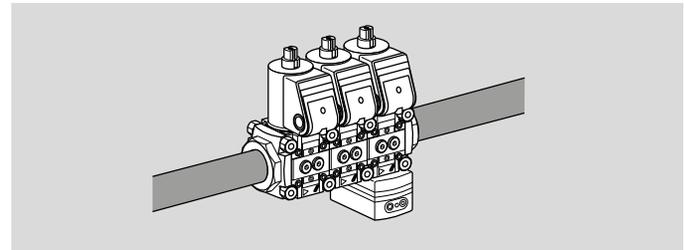
En cas d'installation de plus de trois vannes valVario en série, utiliser un élément support.
