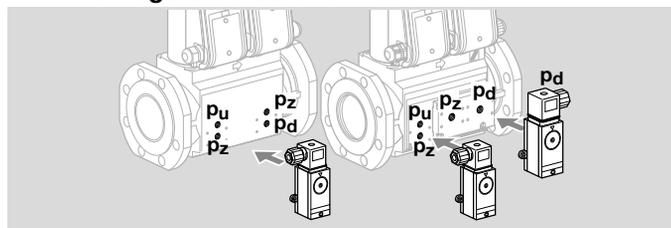
Contrôle de la pression amont  $p_u$ , de la pression intermédiaire  $p_z$ , de la pression aval  $p_d$  : monter les pressostats gaz aux différents endroits indiqués correspondants.
