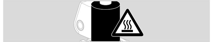
En fonctionnement, la commande magnétique chauffe. Température de surface d'environ 85 °C (185 °F) selon EN 60730-1.
