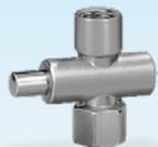
Le robinet de manomètre manuel DH sert de dispositif d'arrêt entre la ligne de mesure et le manomètre. Il permet une dépressurisation durable du manomètre. Le robinet est actionné pour mettre le manomètre en pression et afficher la pression de service.
