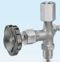
Le robinet d'arrêt de manomètre MH peut être utilisé jusqu'à 100 bar maxi. Pour un réglage du zéro sur le manomètre, la pression contenue entre le manomètre et le robinet peut être purgée à l'aide de la vis à six pans sur le MH.
