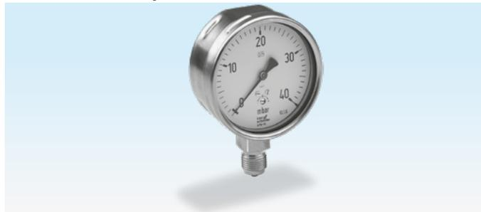
Les manomètres à capsule selon EN 837-3 sont utilisés pour mesurer des pressions faibles jusqu'à 400 mbar maximum. Le fluide mesuré doit être sec et propre.
