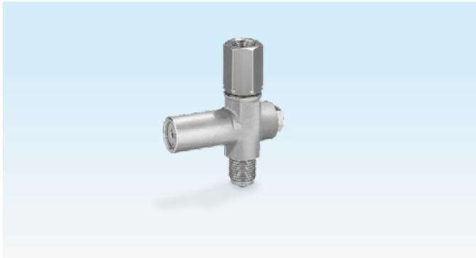
Aussitôt que des surpressions dépassent la pression de fermeture réglée sur l'UDS, le dispositif de protection contre la surpression UDS se ferme et protège le manomètre contre tout dommage.
