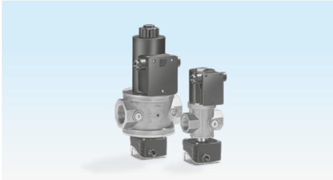
L'électrovanne air VR peut être équipé par la suite d'un microrupteur pour l'indication de la position « fermée » ou « pas fermée » selon le câblage de la séquence de contacts et ce, indépendamment du diamètre nominal.
