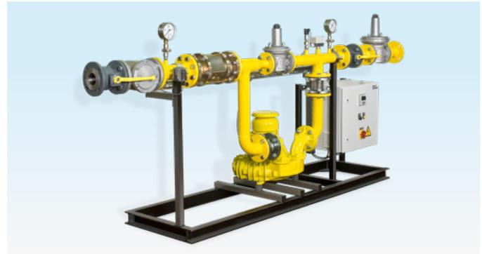
Zu geringe Versorgungsdrücke in industriellen Thermoproszessanlagen oder Blockheizkraftwerken machen den Einsatz von Gasdruckerhöhungseinrichtungen notwendig. Die Drehzahlregelung des Verdichters und damit die Änderung des Ausgangsdruckes bzw. des Volumenstromes erfolgt über einen Frequenzumrichter. Der frequenzgeregelter Verdichter ermöglicht einen großen Regelbereich. Die Steuerung beinhaltet die Sicherheitskette mit Temperatur- und Drucküberwachung.
