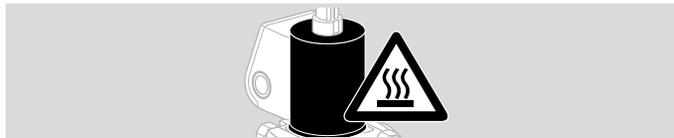
En combinaison avec la vanne papillon BVHM pour air chaud, la commande magnétique peut être utilisée jusqu'à 250 °C (480 °F) et jusqu'à 450 °C (840 °F) avec montage supplémentaire de tôles dissipatrices de chaleur, voir page 10 (Tôles dissipatrices de chaleur).
