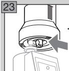
Kople magnet-aktuatoren spenningsfri. Dempingen senkes ned.
