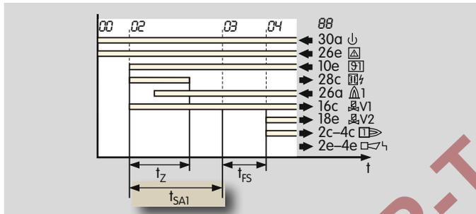
Temps de sécurité au démarrage  $t_{SA1}$  pour le brûleur d'allumage.
