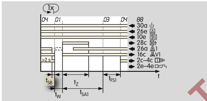
Si le PFU détecte une disparition de la flamme après un temps de service minimal de 2 s, les vannes se ferment et le contact d'indication de service s'ouvre pendant le temps  $t_{SB}$ .
