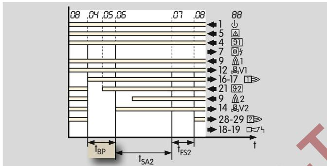
Le temps de pause empêche un redémarrage immédiat du brûleur principal après un arrêt de régulation, une tentative d'allumage, un redémarrage, un refroidissement ou une ventilation. Le temps de pause débute avec l'arrêt de la vanne d'air. Si un signal de démarrage (9) est appliqué avant l'écoulement de ce temps, le démarrage sera retardé jusqu'à la fin du temps de pause.
