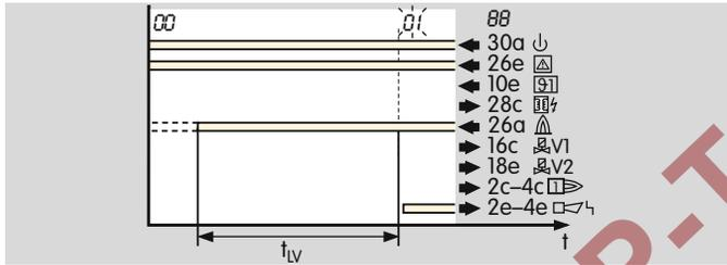
Lorsque le PFU détecte une flamme parasite pendant le contrôle de flamme parasite, il active le temps de temporisation de flamme parasite  $t_{LV}$  (25 s). Si la flamme parasite s'éteint pendant cette période, le brûleur peut démarrer. Sinon, une mise à l'arrêt se produit. Le chiffre i clignote sur l'afficheur en cas de détection de flamme parasite du brûleur d'allumage ou le chiffre 5 en cas de détection de flamme parasite du brûleur principal.
