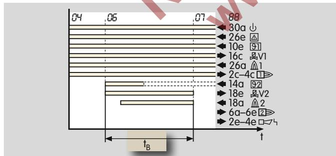
En cas de surveillance du brûleur d'allumage / brûleur principal, la durée de fonctionnement minimum ne se répercute que sur le comportement du brûleur principal. Pour le brûleur d'allumage, la durée de fonctionnement minimum est limitée au temps de sécurité au démarrage ( $t_{SA1}$ ).
