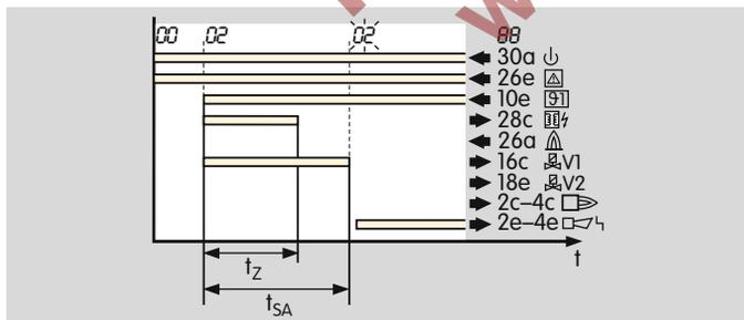
Si aucune flamme ne se forme pendant le démarrage, une mise à l'arrêt est effectuée après l'écoulement du temps  $t_{SA}$ . L'affichage clignote et indique la cause du défaut.
