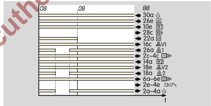
Si la flamme s'éteint lors du fonctionnement haute température, le contact prêt à être mis en service s'ouvre pendant la disparition de la flamme.
