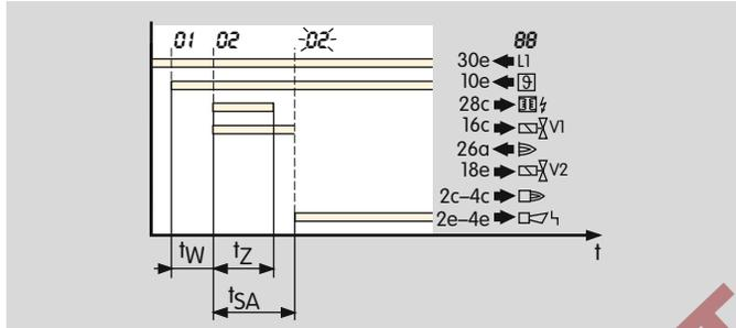
Le temps d'attente  $t_W$  débute après l'application du signal de démarrage  $\Phi$ . Pendant ce cycle, un auto-test est effectué afin de vérifier la sécurité sans défaut des composants de circuit internes et externes. Si aucun dysfonctionnement n'est détecté, le brûleur démarre.
