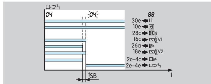
Nach einem Flammenausfall aus dem Betrieb werden innerhalb der Sicherheitszeit  $t_{SB}$  die Ausgänge für die Ventile freigeschaltet.
