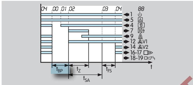
Ein sofortiger Neustart des Hauptbrenners nach Regelabschaltung, Anlaufversuch, Wiederanlauf, Kühlen oder Spülen wird durch die Pausenzeit verhindert. Die Pausenzeit beginnt mit Abschalten des Luftventils. Liegt vor Ablauf dieser Zeit ein Anlaufsignal ( $\theta$ ) an, wird der Anlauf bis zum Ende der Pausenzeit verzögert.
