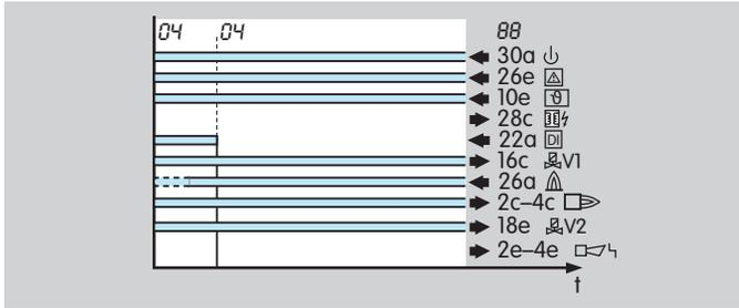
Bei Beendigung des Hochtemperaturbetriebes bleibt der Brenner in Betrieb und die PFU überwacht wieder die Flamme (empfohlen bei Ionisationsüberwachung oder UV-Überwachung mit UVD).
