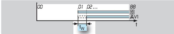
Parameter 15 = 0: Die Fremdlichtprüfung wird nach Anlegen des Anlaufsignals ( $\vartheta$ ) während der Wartezeit  $t_W$  durchgeführt.
