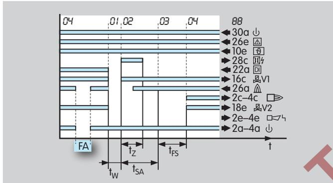
Fällt während des Hochtemperaturbetriebes die Flamme aus, öffnet während des Flammenausfalls (FA) der Betriebsbereitkontakt.
