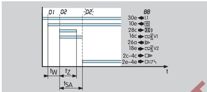
Nach Anlegen des Anlaufsignals  $\Theta$  startet die Wartezeit  $t_W$ . Während dieser Zeit wird ein Selbsttest auf Fehlersicherheit interner und externer Schaltungsteile durchgeführt. Wird keine Fehlfunktion festgestellt, startet der Brenner.
