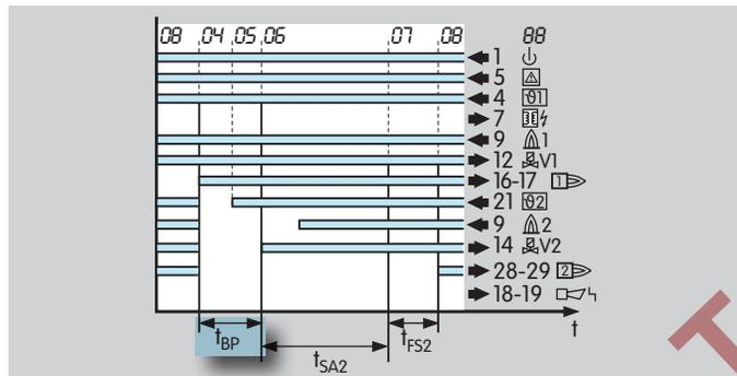
Ein sofortiger Neustart des Hauptbrenners nach Regelabschaltung, Anlaufversuch, Wiederanlauf, Kühlen oder Spülen wird durch die Pausenzeit verhindert. Die Pausenzeit beginnt mit Abschalten des Luftventils. Liegt vor Ablauf dieser Zeit ein Anlaufsignal ( $\theta 2$ ) an, wird der Anlauf bis zum Ende der Pausenzeit verzögert.
