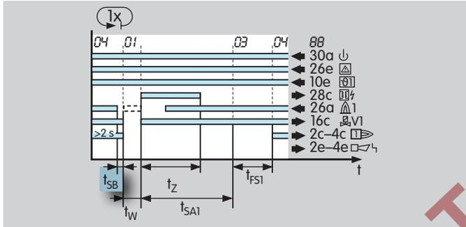
Erkennt die PFU einen Flammenausfall nach einer Mindestbetriebszeit von 2 s, werden innerhalb der Zeit  $t_{SB}$  die Ventile geschlossen und der Betriebsmeldekontakt geöffnet.
