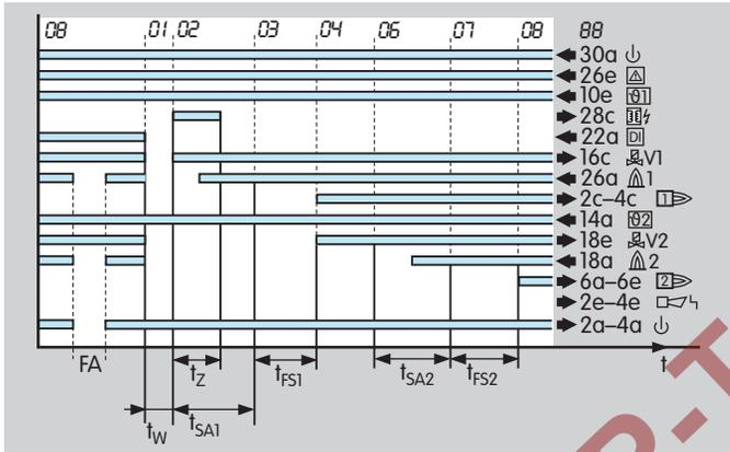
Fällt während des Hochtemperaturbetriebes die Flamme aus, öffnet während des Flammenausfalls (FA) der Betriebsbereitkontakt.
