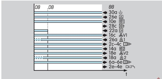
Bei Beendigung des Hochtemperaturbetriebes bleibt der Brenner in Betrieb und die PFU überwacht wieder die Flamme (empfohlen bei Ionisationsüberwachung oder UV-Überwachung mit UVD).
