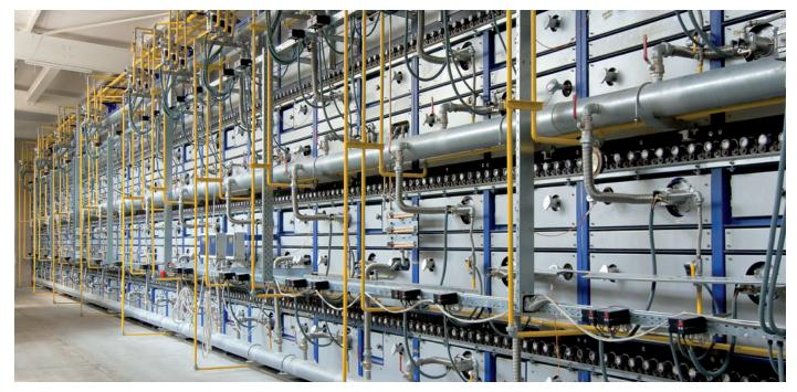
Roller hearth kiln, works photograph Keramischer OFENBAU GmbH
