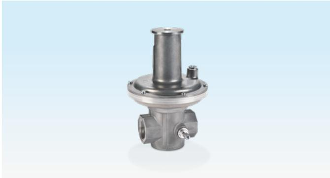
Vanne de décharge pour neutraliser les à-coups de pression momentanés sur les lignes de régulation afin d'empêcher le déclenchement inopiné du clapet de sécurité JSAV. Une montée de la pression trop élevée lors des fuites de gaz causées par des régulateurs de pression gaz qui ne ferment pas hermétiquement est relâchée par la VSVB.
