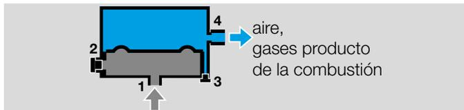
La depresión se mide a través de la cámara superior de la membrana, conexión **4** (o **3**). La cámara inferior de la membrana se ventila a través de la conexión **1** (o **2**).
