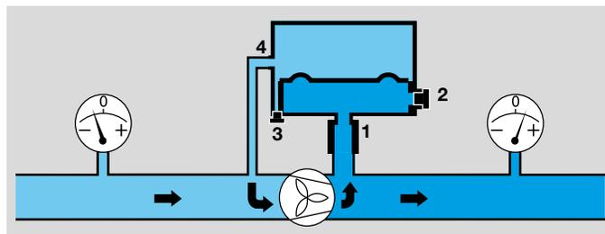
La presión absoluta superior se conecta a **1** (o **2**) y la presión absoluta inferior a **4** (o **3**). Las conexiones que quedan libres se tienen que cerrar herméticamente.
