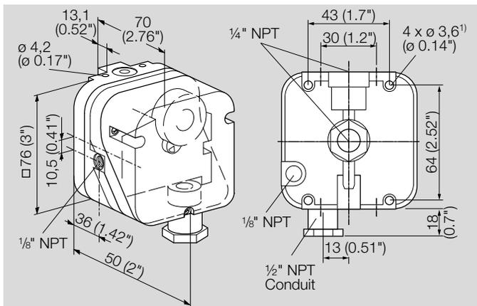
1) Orificios de 10 mm (0,4") de profundidad par tornillos autorroscantes.
