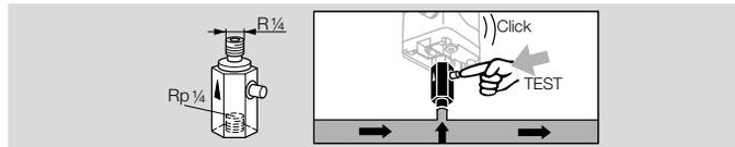
Para ensayar el presostato mín. es posible purgar el aire del DL..ALT conectado por medio del pulsador de prueba del PIA (no está libre de metales no férricos).
