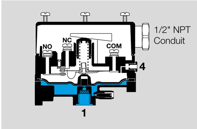
El presostato DL..ALT conmuta por exceso de presión. Cuando se alcanza el punto de actuación ajustado, se acciona un microinterruptor en el presostato que está realizando como contacto de conmutación. La presión de actuación se ajusta a través de una rueda de ajuste manual.
