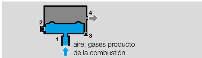
La sobrepresión se mide a través de la cámara inferior de la membrana, conexión **1** (o **2**). La cámara superior de la membrana se ventila a través de la conexión **4** (o **3**).
