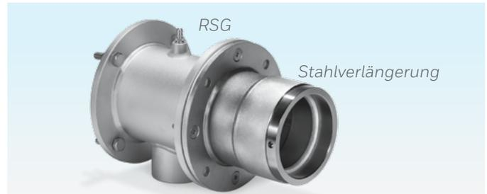
Der Brenner BIC..R und das Ringspaltgehäuse RSG werden als Einheit an die Ofenwand montiert. Über das RSG wird dem Brenner, unabhängig vom primären Brennerbetrieb, zusätzlich Sekundärluft zugeführt. Das Ringspaltgehäuse RSG nimmt das zweite Keramikrohrset TSC auf. Über die Stahlverlängerung für RSG lässt sich der Brenner an verschiedene Ofenwandstärken anpassen.
