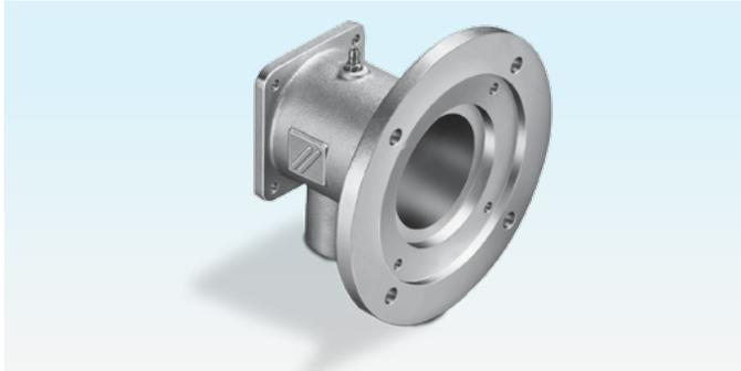
Der Brenner BIC wird über das Brennergehäuse am Ring-spaltgehäuse RSG befestigt. Das Brennergehäuse nimmt den Brennereinsatz und das Keramikrohr TSC auf und führt die Verbrennungsluft. Über einen Luftmess-Stutzen kann der Verbrennungsluftdruck abgenommen werden.
