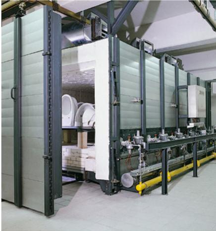
*Keramikofen mit Temperaturregelung über Taktsteuerung*
